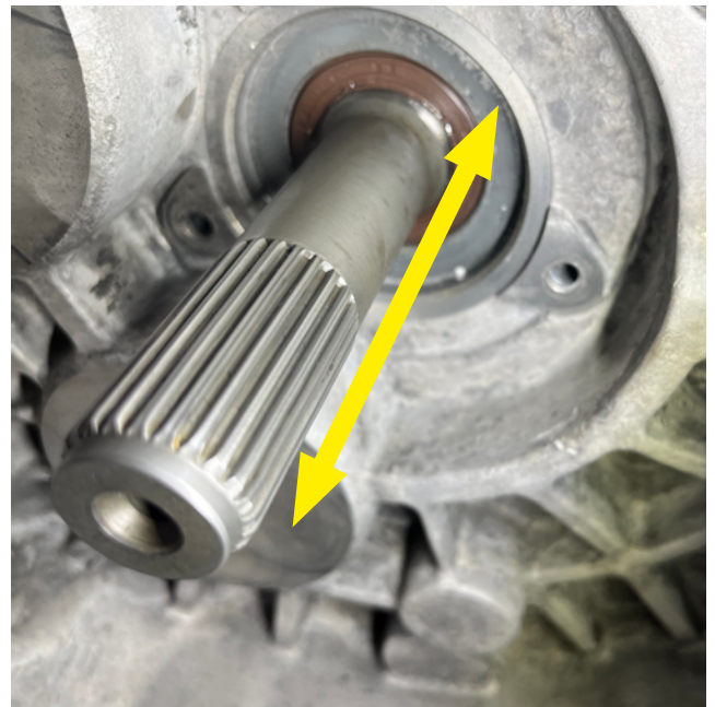
Рис 2: Осьовий „розбіг“ первинного вала коробки передач
